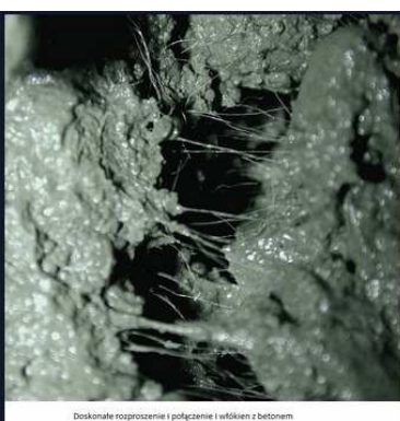
Doskonałe rozproszenie i połączenie włókien z betonem
